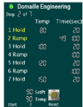
FIG 24. Step & Ramp Step Indicators
